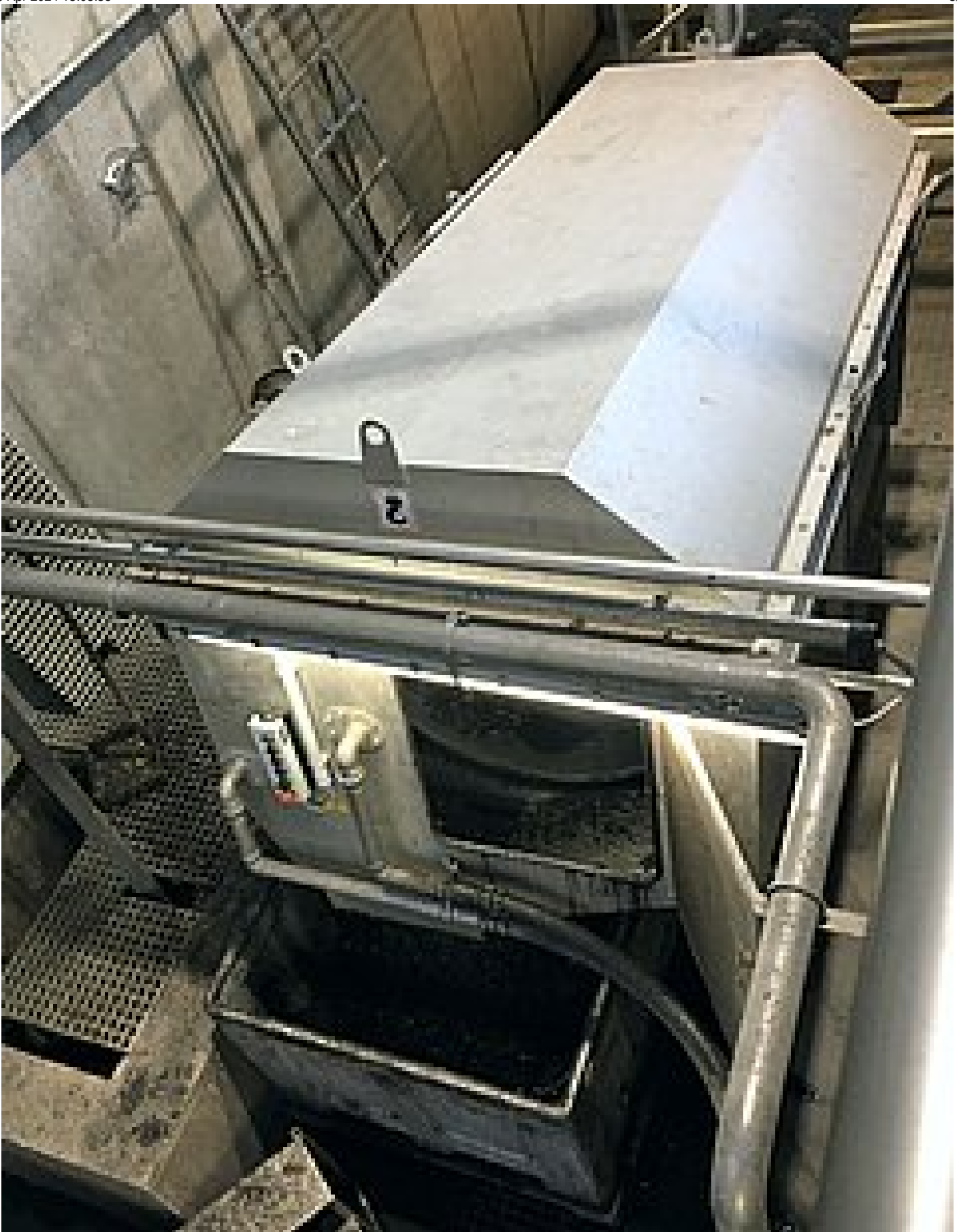
HUBER Waschtrommel RoSF9 zur effizienten und sicheren Abtrennung von Grobstoffen
