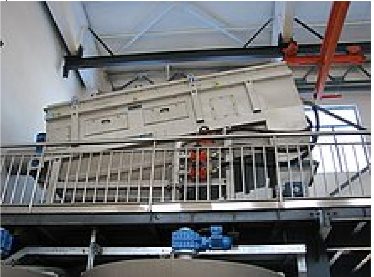
Bild 3: ROTAMAT® Waschtrommel RoSF 9
