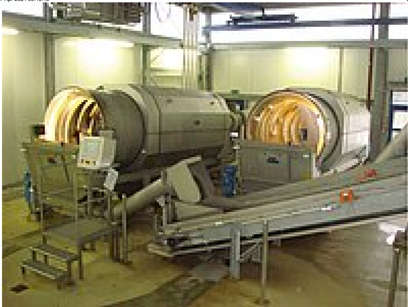
Die ROTAMAT® Waschtrommel: Beschickung direkt vom Sandfang
