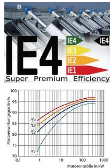
Abbildung: Wirkungsgradanforderung je Wirkungsgradklasse
