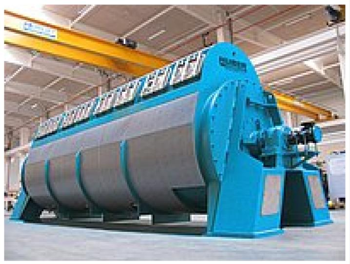
Der HUBER Scheibentrockner RotaDry® ist für die homogene Teil-Trocknung von entwässertem Klärschlamm ausgelegt. Durch seine kompakte Bauform und die hohe spezifische Wasserverdampfung ist er nicht nur für den Einsatz in neuen Klärschlamm-Monoverbrennungsanlagen, sondern auch für Kapazitätserweiterungen bestehender Anlagen bestens geeignet. Der Trockner kann exakt auf den geforderten TR-Gehalt trocknen und so eine selbstgängige Verbrennung in der Wirbelschichtverbrennungsanlage ermöglichen.
